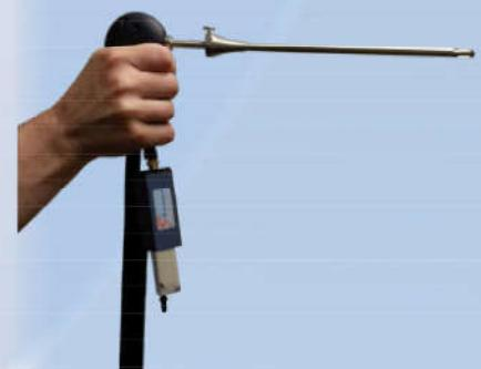
Thiết bị điều hoà mẫu được gắn trực tiếp tại đầu do lấy mẫu, nơi mà độ ẩm ngưng tụ nhanh và tách ra khỏi mẫu khí. Điều này giảm thiểu sự tiếp xúc của khí có độ ẩm, nó có thể ảnh hưởng đến việc đo NOx và SO<sub>2</sub>.
